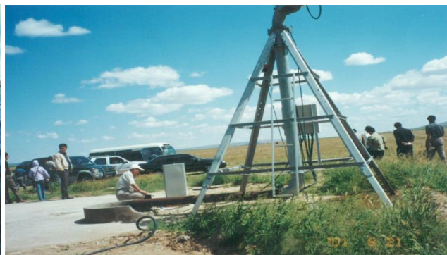
图10 此为内蒙古锡林格勒盟草原牧区的“万亩节水灌溉饲料地”装置为奥在利生产的TX50/125型转盘式喷灌机为井位，井深80-100米，出水量50吨/时，土质为沙性栗钙土，以种披碱草，老芒麦牧草为主。由于去年未灌水牧草长不好，且一块块的空斑化，仅约生产干草75公斤/亩。当时我国北方天然草地中人工草地约占0.5%，要求达到2-3%就可缓解当时人工饲料严重不足问题。
