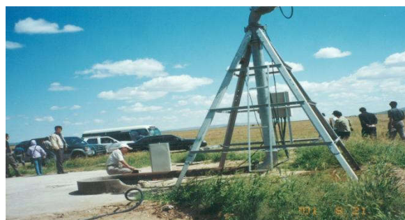
图 1-4 此为内蒙古锡林格勒盟牧区的“万亩节水灌溉饲料地”装置为奥在利生产的 TX50/125 型转盘式喷灌机为井位，井深 80-100 米，出水量 50 吨/时，土质为沙性栗钙土，以种披碱草，老芒麦牧草为主。由于去年未灌水牧草长不好，且一块块的空斑化，仅约生产干草 75 公斤/亩。当时我国北方天然草地中人工草地约占 0.5%，要求达到 2-3% 就可缓解当时人工饲料严重不足问题 2001.8.24
