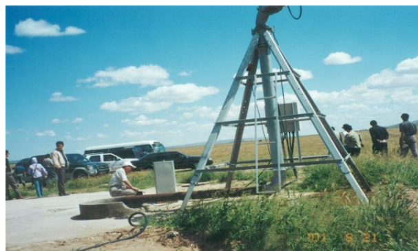
图 2-12 此为内蒙古锡林格勒盟的“万亩节水灌溉饲料地”装置为奥在利生产的 TX50/125 型转盘式喷灌机为井位，井深 80-100 米，出水量 50 吨/时，土质为沙性栗钙土，以种披碱草，老芒麦牧草为主，由于去年未灌水牧草长不好，仅约生产 75 公斤/亩。当时我国北方天然草地中人工草地不足 2%，只要求达到 3%就可缓解当时人工饲料严重不足问题。
